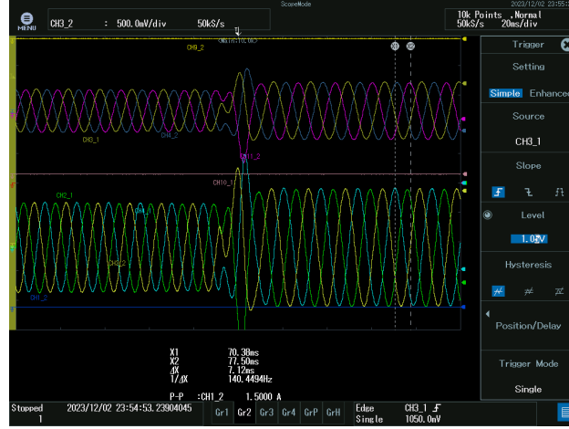
(a) Desconexão com demora de 20ms.
